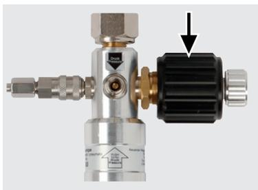
Установите с помощью клапана тонкой регулировки (показан стрелкой) требуемое давление.
