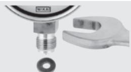
Zur Abdichtung der Druckmessgeräteanschlüsse mit zylindrischen Gewinde an der Dichtfläche ① sind Flachdichtungen, Dichtlinsen oder WIKA-Profilabdichtungen einzusetzen. Bei kegeligen Gewinde (z. B. NPT-Gewinde) erfolgt die Abdichtung im Gewinde ②, mit zusätzlichen Dichtwerkstoffen, wie z.B. PTFE-Band (EN 837-2).
