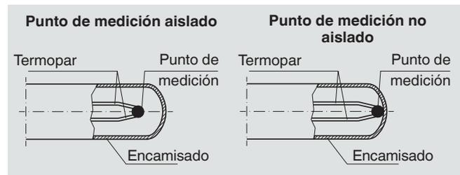
El termopar se entregará como un solo termopar con un punto de medición sin conexión a tierra, a menos que se especifique explícitamente lo contrario.
