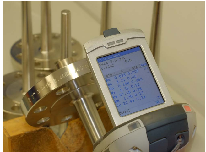
Test PMI : analyse de fluorescence aux rayons X de la tige du doigt de gant
