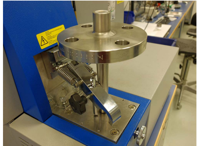
Test PMI : analyse spectrographique sur un doigt de gant à bride type TW10
